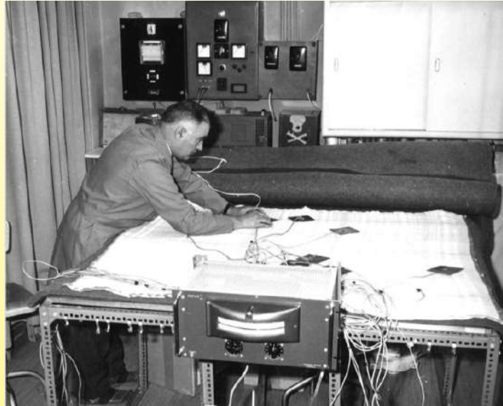
Messung der Oberflächentemperatur der Heizdecke (ca. 1960, Vedette, Ultimheat Museum)
