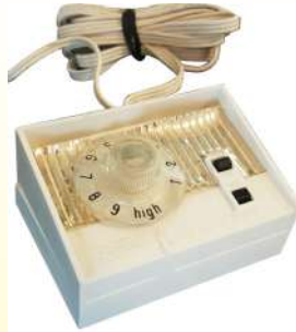
Ca. 1970. Leistungseinstellung von GEC (General Electric, England) an einer englischen Heizdecke. Der zu erwartende Widerstand ist deutlich über dem Bimetall und dem langsamen Unterbrecher zu erkennen. (Ultimheat-Sammlung).
