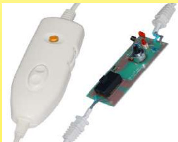
2019 Kontinuierliche elektronische Leistungsregelung Gummituch-Regelgerät (Ultimheat-Sammlung)
