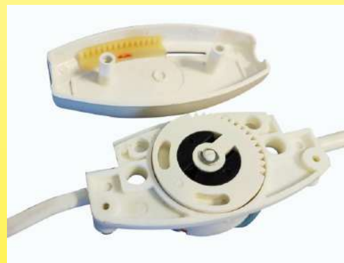
3-Stellungs-Heizungsschalter und 2-Stellungs-Stoppeschalter auf der Heizdecke. Zwischenmodell zwischen Rotationssystemen und Schiebesystemen (ca. 1970, Gitem, Ultimheat-Sammlung)
