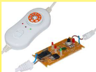
2019 Kontinuierliche elektronische Leistungsregelung Gummituch-Regelgerät (Ultimheat-Sammlung)
