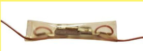
Temperaturbegrenzer für Calor-Heizmatten mit langsamer Unterbrechung, geeicht auf 80°C (ca. 1960). Man beachte die wasserdichte PVC-Hülle, die auf die Drähte geschweißt ist, und die Schleife, die durch die elektrischen Leiter gebildet wird, die durch ein Loch in jeder Klemme geführt werden - dies dient dazu, Zugspannungen auf den Draht zu vermeiden (Ultimheat-Sammlung).
