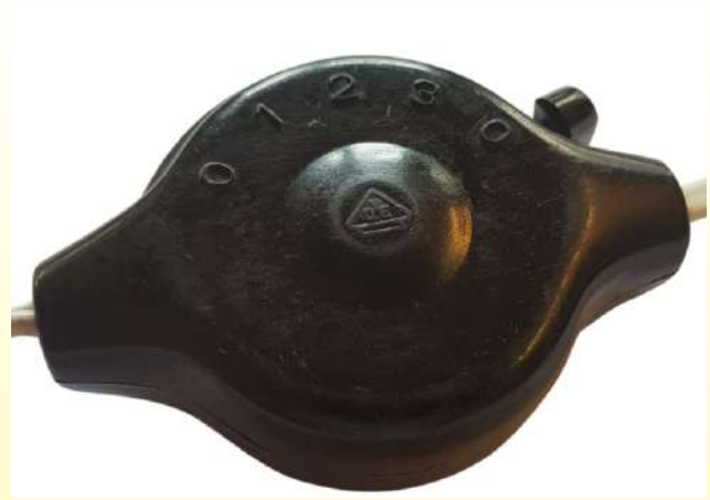
Ca. 1955. 5-Stellungs-Drehesalter ähnlich dem Modell Cuhe, jedoch mit Schnappschalter (deutsche Herstellung LW Lohmann und Welschehold GmbH & Co. in Meinerzhagen). (Ultimheat-Sammlung)
