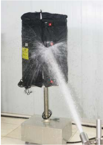
IPx6-Prüfung von Heizmänteln
